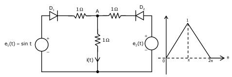
(d) Determine the output voltage  $V_0$  of the circuit shown in the figure.
